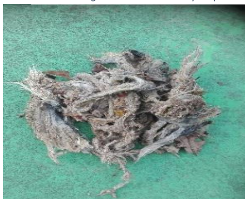
Débris de lingettes retirées d'une pompe
